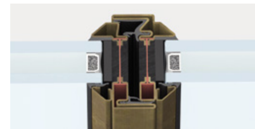
nodo centrale | sezione in vista 62 mm
