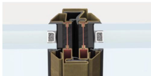
nodo centrale | sezione in vista 62 mm
