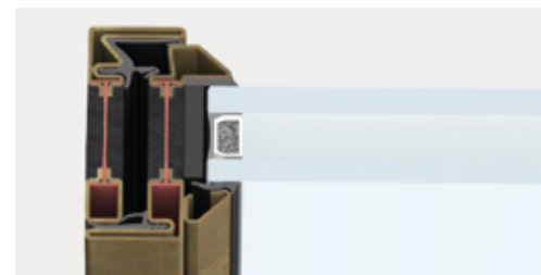
nodo laterale | sezione in vista 47 mm
