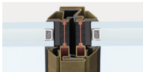
nodo centrale | sezione in vista 62 mm
