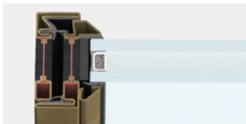
nodo laterale | sezione in vista 47 mm
