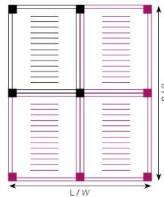
MODULO QUADRUPLO ACCOPIATO IN PROFONDITÀ Dimensioni massime: L 1000 x S 1197,2 QUADRUPLE MODULE COUPLED ON DEPTH SIDE Max dimensions: W 1000 x P 1197,2
