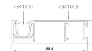
Guida singola standard per il sistema F-A.
