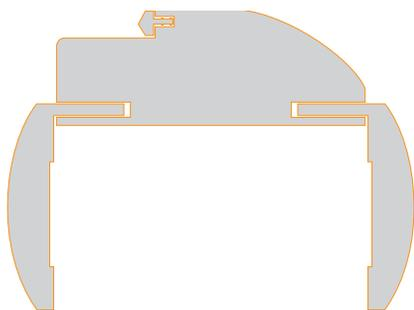
Telaio a raggio r. 50 e coprifili bombati telescopici
