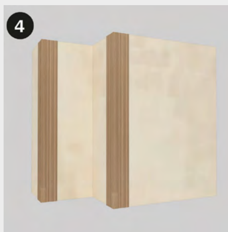
Incollare il primo modulo adiacente al profilo angolare appena installato premendo leggermente per fissarlo in posizione.
