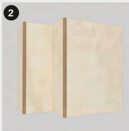
Incollare il primo angolare sugli angoli esterni, premendo leggermente per fissarli in posizione.
