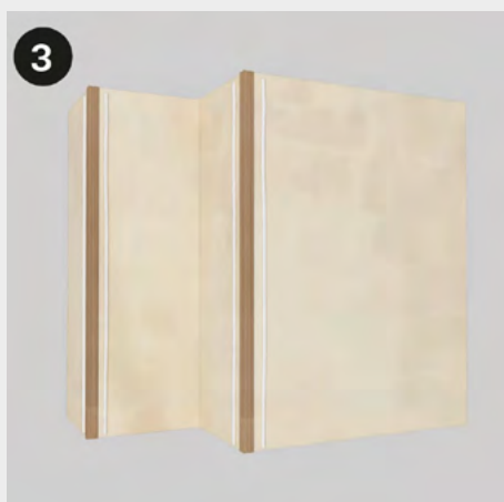
Continuare ad applicare l'adesivo murale a partire dagli angoli esterni della parete.
